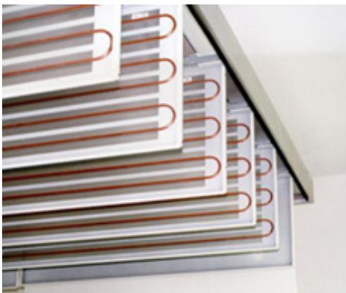
Назначение охлаждающего потолка - поглощать как можно больше тепла посредством холодной воды в змеевике. Находящиеся в помещении источники тепла отдают избыточное тепло охлаждающему потолку непосредственно - через излучение - и косвенно - через конвекцию. Так происходит охлаждение помещения.
